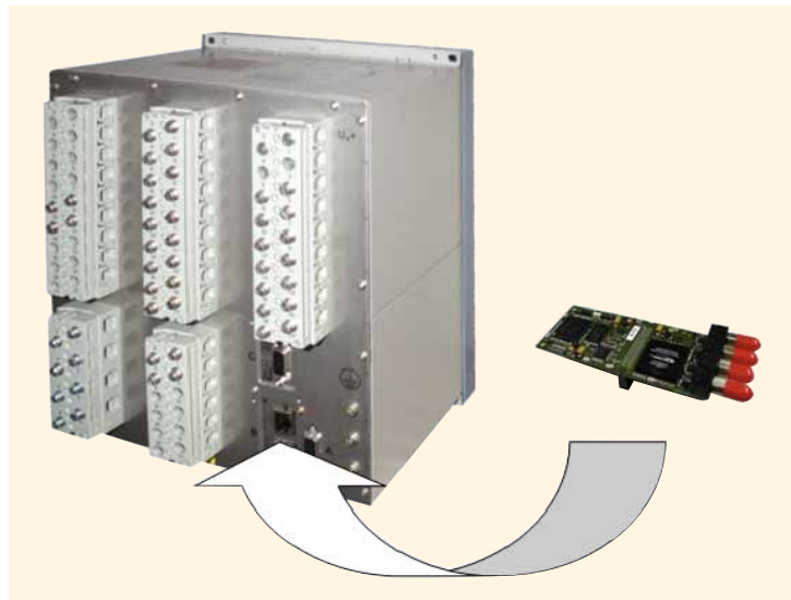
Bild 3 Upgrade eines bestehenden Gerätes mit IEC 61850
