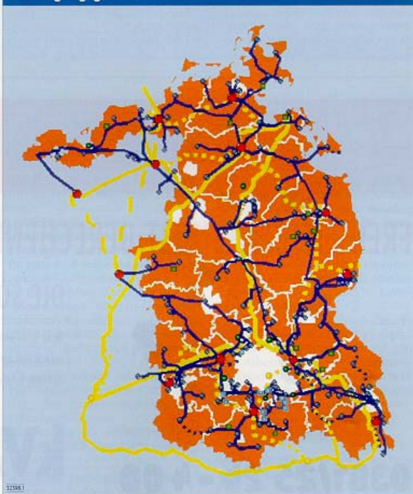
Bild 1. Anlagen des Edis-Netzes, Umspannwerke und Leitungen: Das Versorgungsgebiet der Edis AG erstreckt sich entlang der Ostseeküste von Schönberg bei Kiel bis Usedom über die beiden Bundesländer Mecklenburg-Vorpommern und Brandenburg von Rügen bis Jüterbog. Auf diesem Gebiet betreibt das Energiedienstleistungsunternehmen 146 Umspannwerke und 5.266 km 110-kV-Freileitungen
