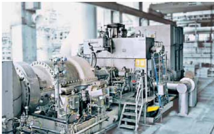
Порт Диксон, Малайзия, паротурбинная установка мощностью 44 МВт для нефтеперерабатывающего завода, предназначенная для привода воздуходувки.
