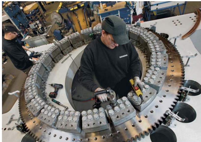
Montage des Windrichtungsnachführsystems. Qualität und fachgerechte Ausführung legen das Fundament für die Zuverlässigkeit von Siemens Windenergieanlagen
