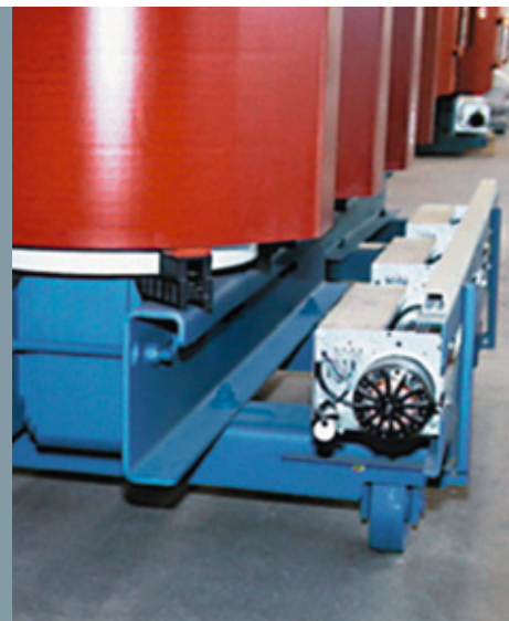
Leistungserhöhung um ca. 25 % durch Anbau von Querstromlüftern.
