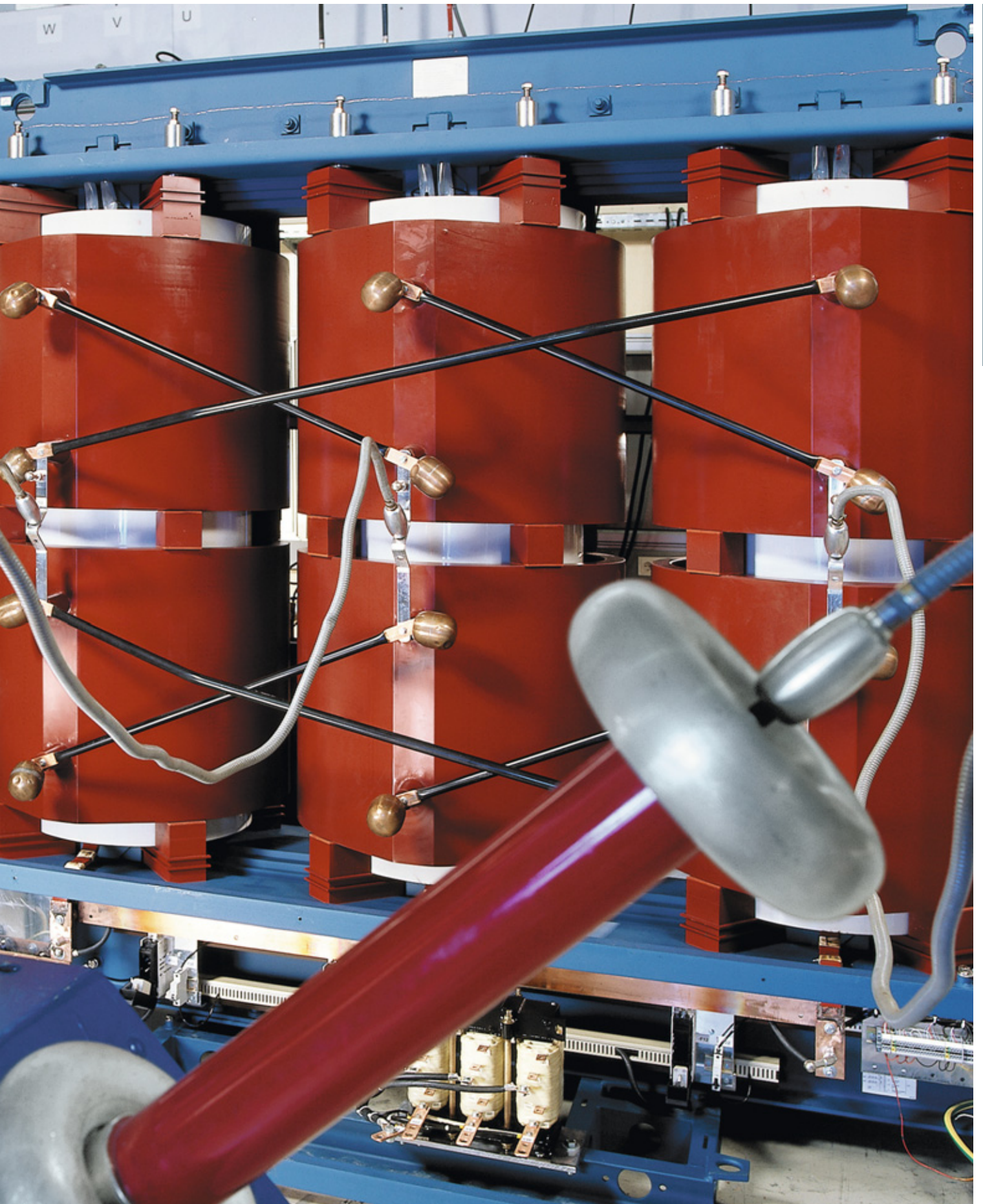
Die Qualität der Herstellung wird von der Disposition bis zur Übergabe des Trafos an den Kunden gesichert: Eine besonders wichtige Station ist die mechanische und elektrische Endkontrolle des fertigen Produkts.
