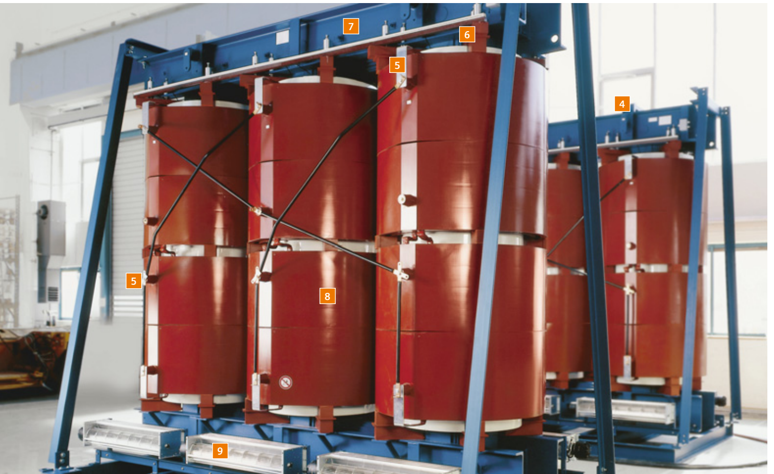
Die Wärmedehnung der Spulen wird vom Spulen-Support-System per Federdruck kompensiert.
