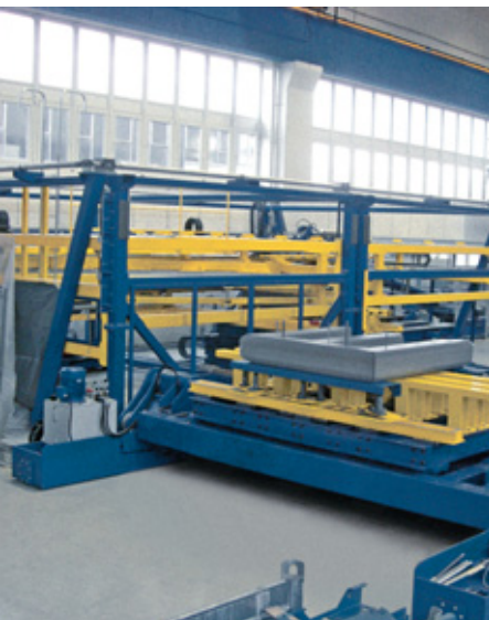
Modernste Fertigungstechnik: vollautomatische Stanz-Kernlegeanlage.
