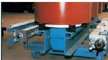
Leistungserhöhung um bis zu 50 % durch Anbau von Querstromlüftern
