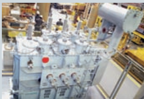
Transformador com 2 secundários e ventilação forçada, 9/12 MVA, destino Costa Rica
