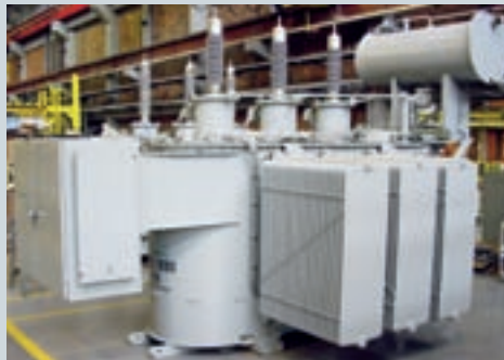
15/20 MVA LDT, 46 +/- 8x1,875% / 6,3 kV, OLTC, para o Equador
