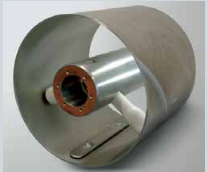
Querschnitt durch ein GIL-Rohr der zweiten Generation: Leiter- und Mantelrohr, Stützerpaar, durchgängige Teilchenfalle
