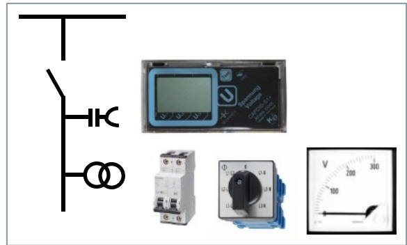
Spannungsmessung mit klassischen Spannungswandlern (oben) und optionale Konfiguration mit kapazitivem Teiler (unten)
