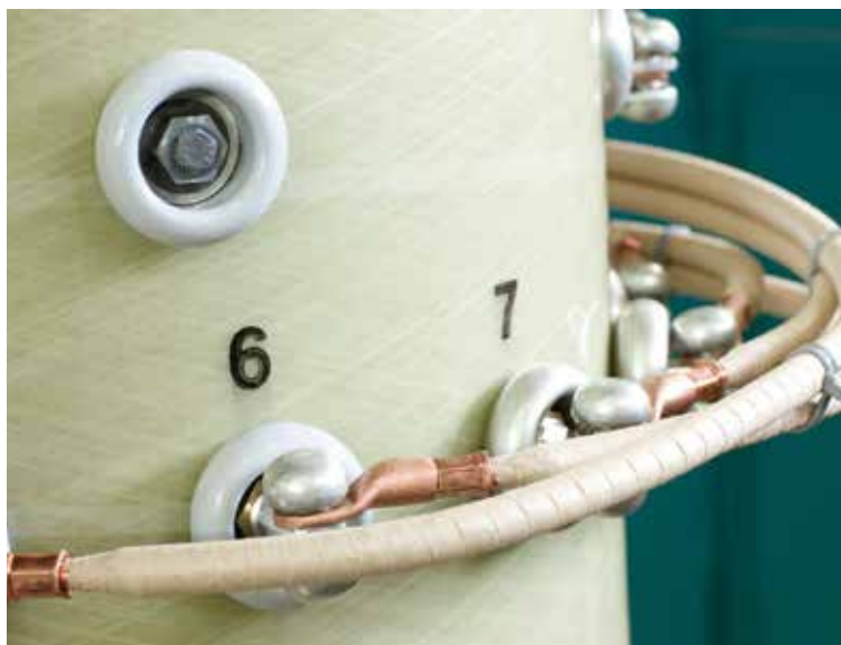
Stufenschalter und Umsteller sorgen für eine gleichbleibende Ausgangsspannung
