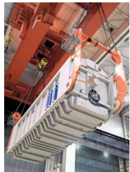
Dieser Kessel ist speziell für den Transport im Schnabelwagen gebaut
